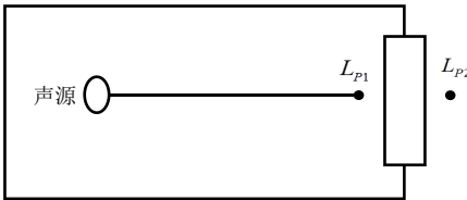
图 B.1 室内声源等效为室外声源图例
