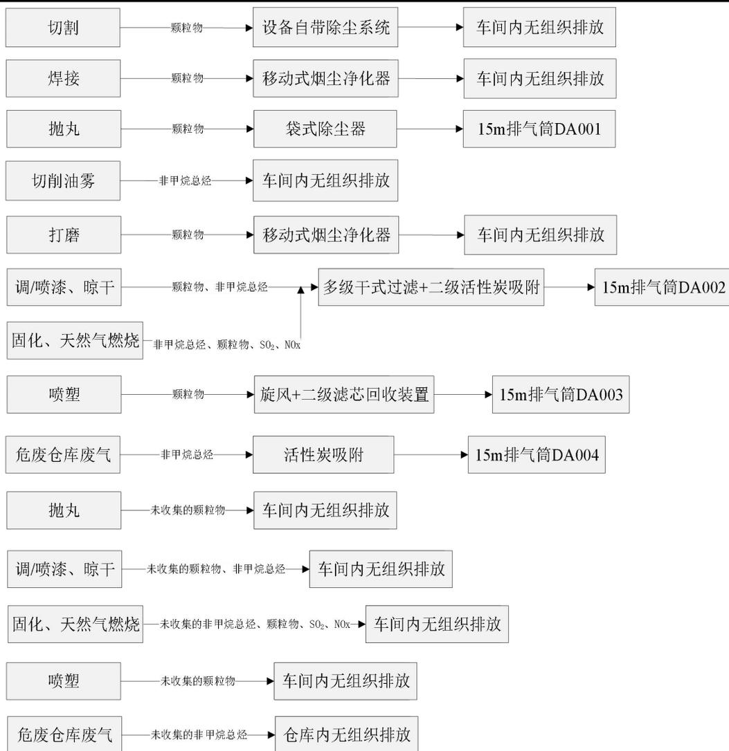
图 4-1 项目废气收集、处理方式示意图
