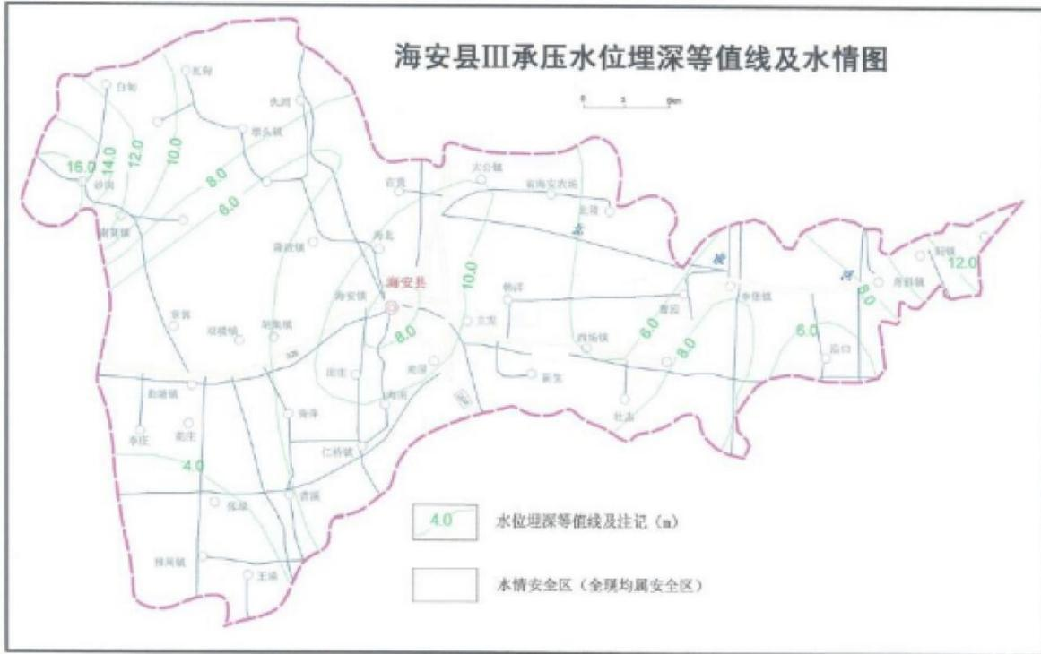
图 6.2-3 海安市承压水位等值线及地下水流场图
